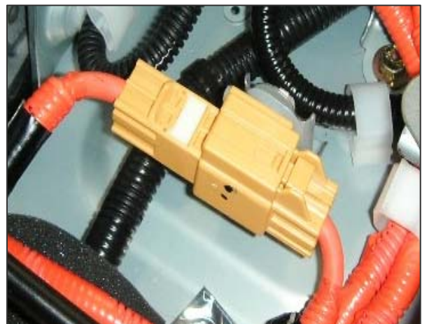
Example HV Wiring (orange)
